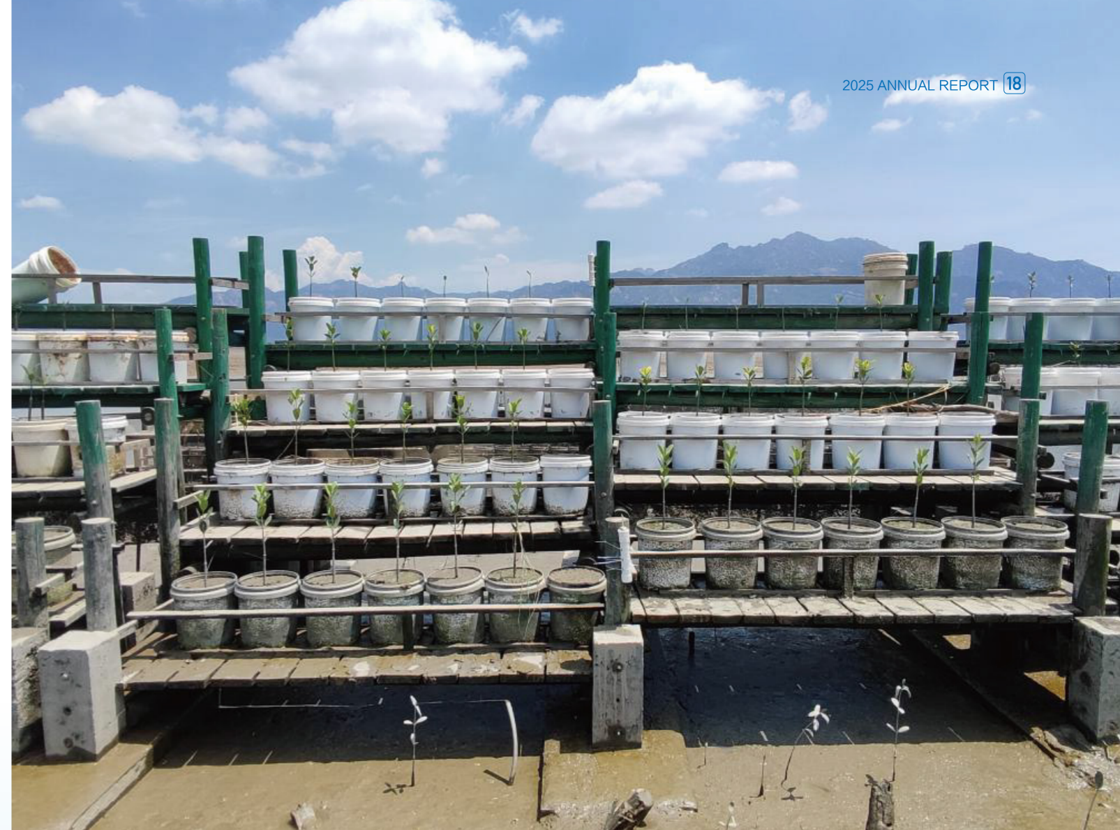
水位梯度控制实验系统 Water Level Gradient Control Experimental System
